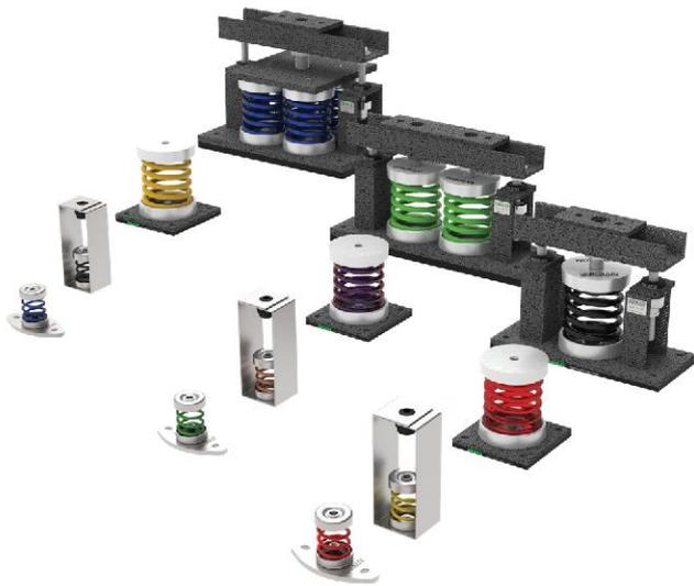
لرزه گیرهای فنری شرکت لینکران در سه نوع پلیت دار، اسپرینگ هنگر (Spring Hanger) و مهاردار (به شکل تک فنره، دو فنره و چهار فنره) تولید می‌شوند که برای کاهش انتقال نویز، شوک و ارتعاش تولید شده توسط تجهیزات مکانیکی و صنعتی همچون پمپها، برج‌های خنک کننده، چیلرها، دیگ‌های بخار و کمپرسور استفاده می‌گردند. همچنین این نوع لرزه گیرها برای جذب بارهای نوسانی با فرکانس‌های متفاوت و بارهای جانبی وارده به سازه توصیه می‌شود.
